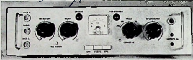
FRONTPLAAT VAN DE VERSTERKERS. V.l.n.r.: Ingangen voor hoog- en laagohmige microfoons en radio (of p.u., enz.) niveau- (en meng-) regelaars voor microfoon- en „radio” kanaal, niveau- meter met daaronder druktoetsen voor omschakeling van niveau- meter en afluisterversterker op voor- resp. weergeefversterker, schakelaar voor vijf verschillende weergeef karakteristieken, sterkteregelaar voor de afluisterversterker, uitgang van weergeef- versterker alsmede aansluiting voor externe luidspreker. Het signaallampje rechts van de meter brandt wanneer de weergeef-, voor- en afluisterversterkers in bedrijf zijn, het linker lampje brandt wanneer opneemversterker en h.f. generator zijn inge- schakeld (via de functieschakelaar op het dek).
